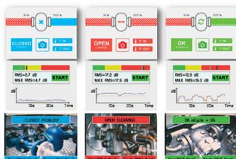
Parce que les fuites de vapeur causées par des purgeurs défectueux représentent un gaspillage énergétique majeur, le LKS 1000-V3 intègre, en plus de la détection de fuites d'air comprimé, un nouveau concept inédit de programme de diagnostic de purgeur vapeur. Le LKS 1000-V3 utilise
