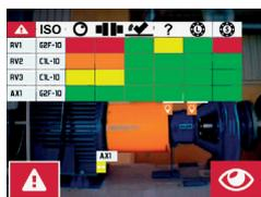
Photo fusion avec positionnement des capteurs et code couleur selon ISO
