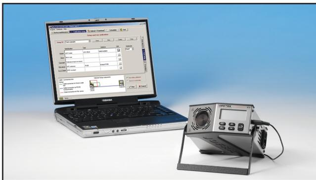
Utilisation du calibrateur ETC avec le logiciel d'étalonnage JOFRACAL
