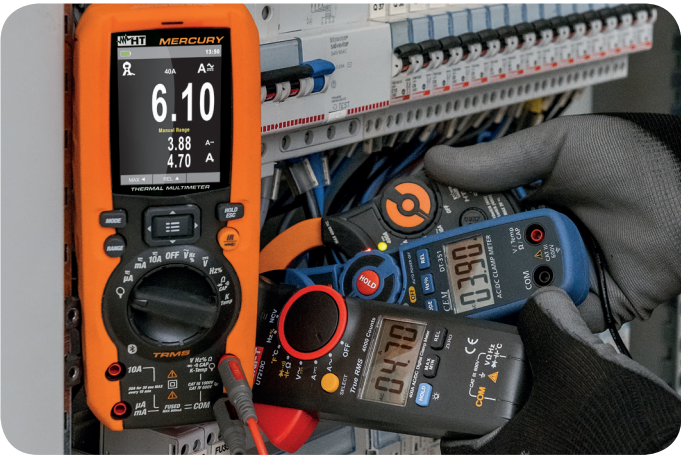
Comparaison des lectures: 3.9 A avec pinces RMS, 4.7 A avec pinces TRMS, 6.1 A (lecture correcte) avec pinces AC+DC.
