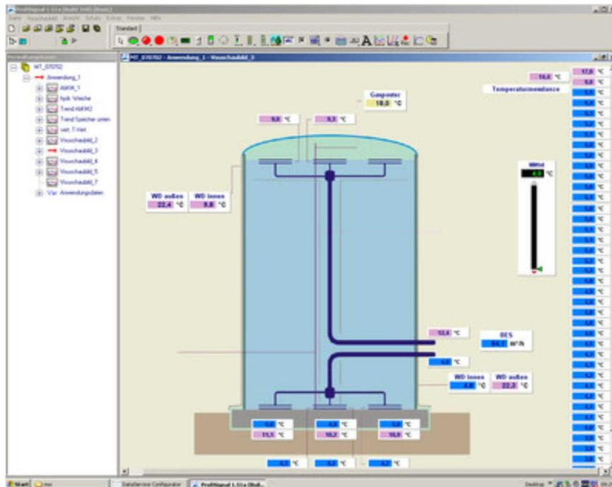
ProfiSignal Basic est un outil de développement permettant de générer des applications individuelles avec des schémas de visualisation, des diagrammes de tendances, etc. Par un simple clic de souris ou en mode automatique en ouvrant l'application, on change en temps de fonctionnement, où l'application peut être utilisée par l'utilisateur.
