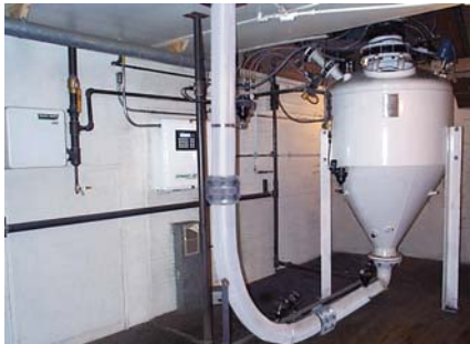
Système de transport pneumatique de blé en phase dense suivant le Concept de la Ligne Pleine™.
