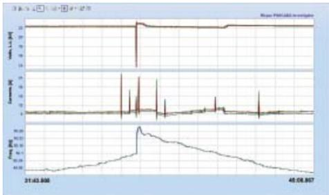
En dernier lieu, en élargissant encore la vue sur un total de 250 000 cycles de données d'exploitation de formes d'ondes, avec plus d'un milliard d'échantillons, il est visible que ces présentes crêtes sont habituelles sur ce site et que la baisse actuelle de tension était du côté de l'utilitaire, suivie par de nombreuses charges se déplaçant à travers le réseau produisant l'augmentation de fréquence.
