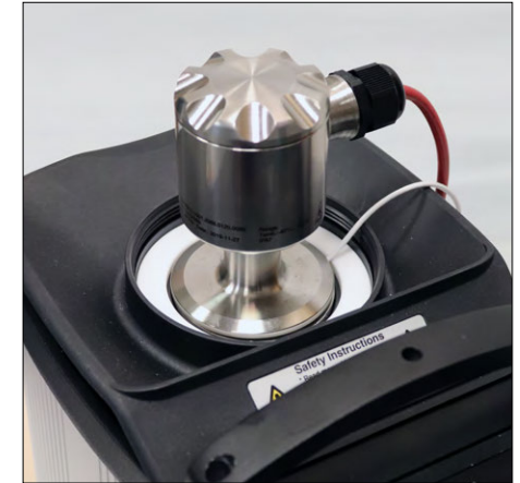
Le calibrateur RTC-168 avec des fonctionnalités mises à jour pour l'étalonnage de capteurs sanitaire et courts, utilisant le mode sec ou liquide
