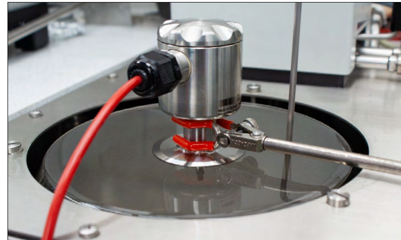
Etalonnage d'un capteur sanitaire dans un bain de laboratoire traditionnel
