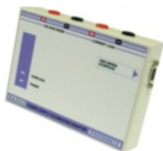
Option essentielle pour faciliter l'étalonnage de sources d'alimentation, l'adaptateur mesure la tension de sortie et fournit un courant de charge de précision permettant de les étalonner à la fois en tension, courant et même résistance. La mesure en 4 fils garantit la précision et la répétabilité des performances.
