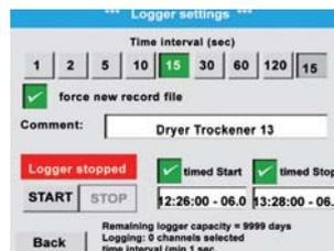
Il est possible d'enregistrer jusqu'à 100 millions de valeurs mesurées. Chaque mesure peut être sauvegardée avec un commentaire, par exemple, le point de mesure. L'intervalle de temps peut être déterminé librement.
