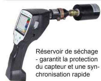
Réservoir de séchage - garantit la protection du capteur et une synchronisation rapide
