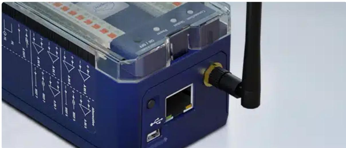
L'enregistreur Loggito est équipé d'une mémoire de données interne et permet le prétraitement et le calcul internes des canaux de mesure.
