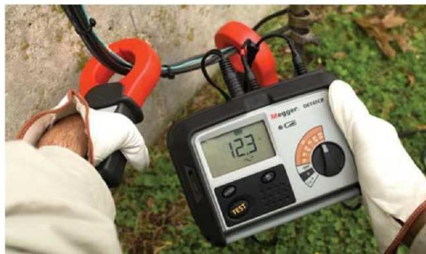
Les DET4TC2 et DET4TCR2 permettent de tester la terre sans piquet, en utilisant seulement des pinces.
