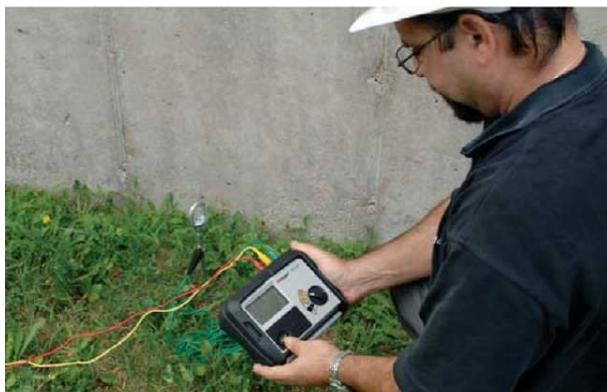
Le DET3TD permet d'utiliser la méthode de test classique de la chute de potentiel.
