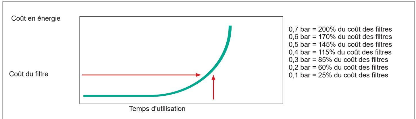
Diagramme : pression différentielle type, coût de l'énergie en fonction du prix des éléments filtrants
