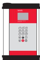
Le KATflow 230 est un débitmètre portable très performant. Il bénéficie de caractéristiques avancées correspondant aux situations exigeant des mesures complètes, ainsi qu'un fonctionnement facile. Le débitmètre est doté de deux voies de mesure pour
