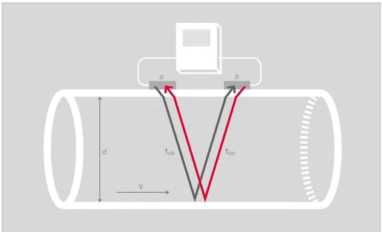
Fonctionnant en alternance, les capteurs *a* et *b* émettent et reçoivent des impulsions ultrasoniques. Les ondes sonores de *a* vers *b* se propagent avec l'écoulement plus rapidement que celles se propageant en sens inverse de *b* vers *a*.
