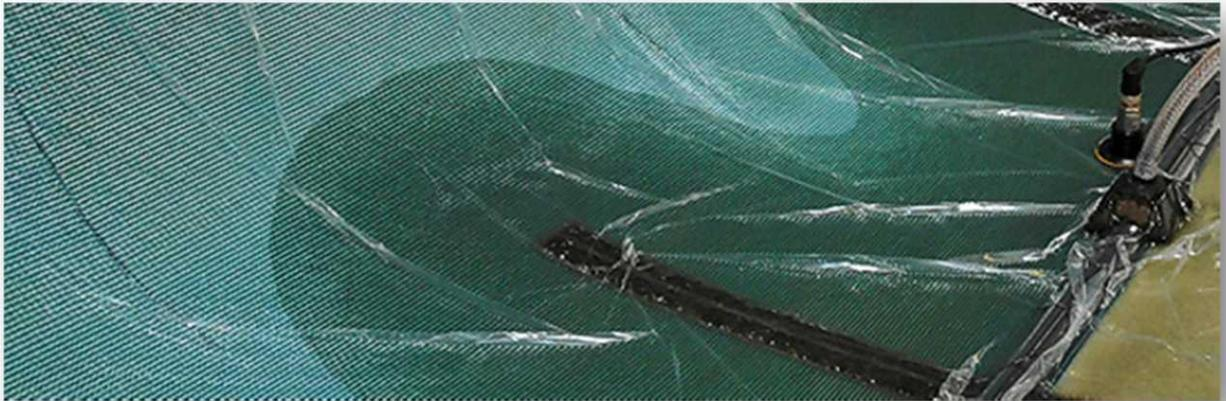
*Exemple de pièce en cours d'infusion par injection de résine*
