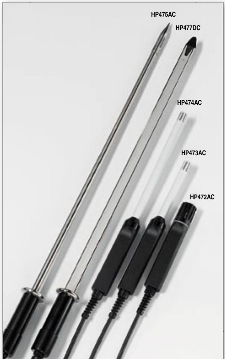
**HP475AC** Sonde accouplée %HR et température. Poignée Ø 26x110 mm. Sonde Inox Ø12x560 mm. Extrémité Ø 13,5x75 mm. Câble de raccordement: 2 mètres.
