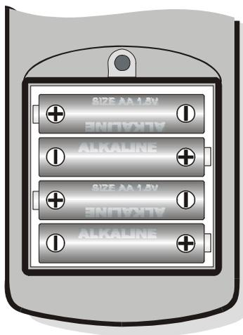
**Après le changement de piles, il faut régler de nouveau la date, l'heure, le baud rate, le type de sonde, l'intervalle d'impression, les paramètres de logging: pour simplifier l'opération, lors de l'insertion des nouvelles piles, l'instrument s'allume automatiquement et demande par la suite**
