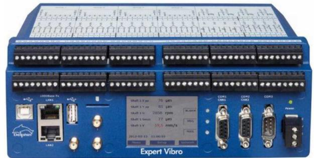
Ses convertisseurs A/D 24-Bit permettent d'assurer une haute précision. Les utilisateurs peuvent basculer entre la mesure de tension, IEPE ou de capteurs de vibrations d'arbre. Les comparateurs intégrés et les entrées numériques permettent un déclenchement flexible. Les données de mesure sont contrôlées "au fil de l'eau" avec des sorties numériques commutés en ms en cas d'un dépassement de seuil.
