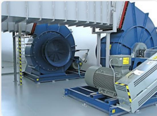
Le balourd est critique dans les installations a ventilateurs (transmission directe ou poulie courroie)
