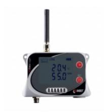
L'enregistreur de données GSM est conçu pour enregistrer la température et l'humidité de l'humidité. En cas de dépassement des limites définies, les messages SMS et JSON peuvent être envoyés via une connexion de données GPRS. Il est possible de définir l'envoi régulier de messages JSON à la base de données COMET, l'intervalle d'envoi est réglable. L'enregistrement est effectué dans une mémoire électronique non volatile. Les données peuvent être transférées sur un PC via USB-C.
