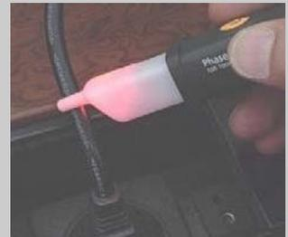
Détection de tension alternative (AC)
