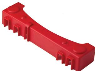
La classe de sécurité CATIII 300 V du DLRO10HD n'est valide que lorsque l'appareil est équipé du cache-bornes optionnel qui permet de garantir des lignes de fuite suffisantes. Bien que le cache-bornes
