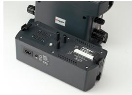
Photo du DLRO10X équipé du module optionnel DLRO10LPU
