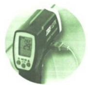
Entrée Thermocouple K sur le côté du pyromètre.
