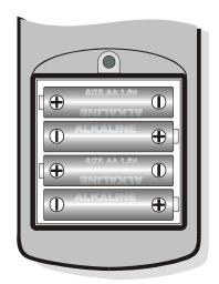
Après le changement de piles, il faut régler de nouveau la date, l'heure, le baud rate, le type de sonde, l'intervalle d'impression, les paramètres de logging: pour simplifier l'opération, lors de l'insertion des nouvelles piles, l'instrument s'allume automatiquement et demande par la suite
