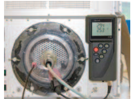
Klimaschrankprüfungen Quality control of climatic cabinets
