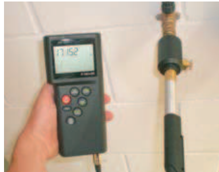
Restfeuchtefühler für Druckluftanlagen (bis 25 bar druckdicht) Pressure-tight moisture probe for measuring in compressed air
